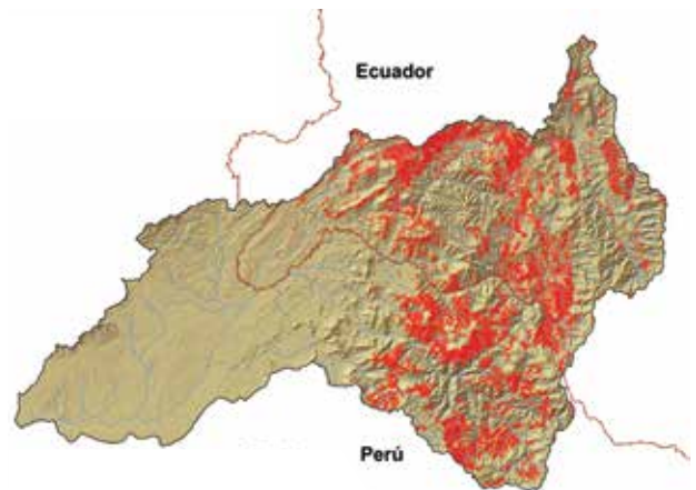
Figura 19. Riesgo de movimientos en masa
